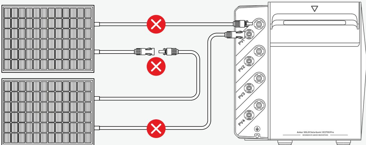
Niemals denselben Satz PV-Anschlüsse an unterschiedliche Sätze PV-Eingangsanschlüssen anschließen. So ist es beispielsweise verboten, den positiven Anschluss von PV-Modul 1 mit dem negativen PV2-Eingang von Solarbank zu verbinden.
