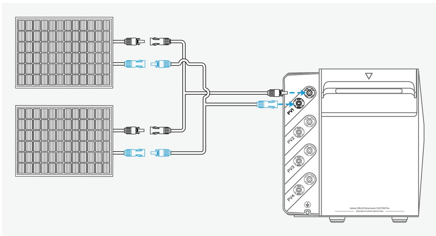
Verwenden Sie zum Trennen der PV-Anschlüsse den mitgelieferten Schraubenschlüssel.
